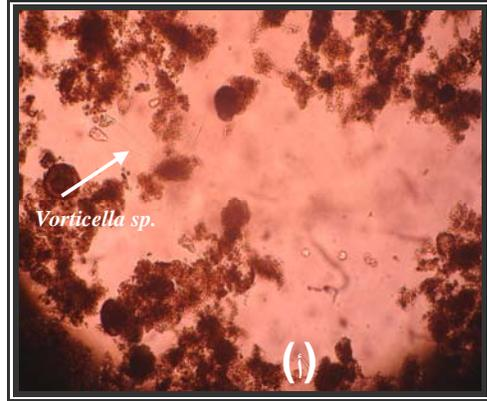
شكل 4: تكون الندف والتكتلات الأحيائية في عمود المياه الخارجة من أحواض التهوية في محطة معالجة مياه الصرف الصحي/الرستمية:
