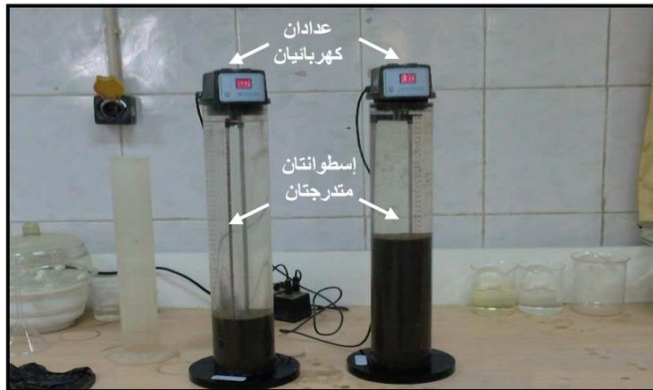
شكل 1: جهاز قياس دليل حجم الحمأة
